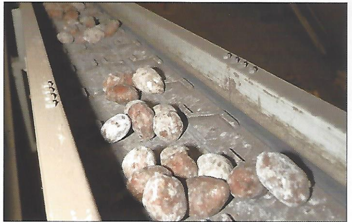
Verderop in de sorteerlijn verdeelt de kalk zich mooi rondom de knollen als gevolg van het omrollen in de productstroom.
